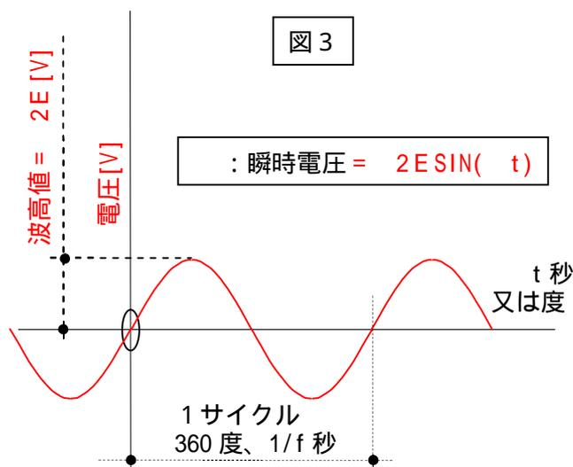
横軸に時間又は角度を取って、縦軸に電圧値 [V] を取り、グラフ化すると図 2 の様になります。
