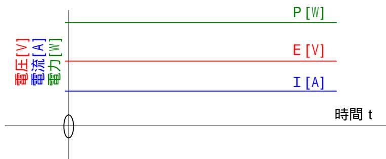
上図は直流の場合の瞬時電力、瞬時電圧、瞬時電流の関係をグラフ化したものです。
